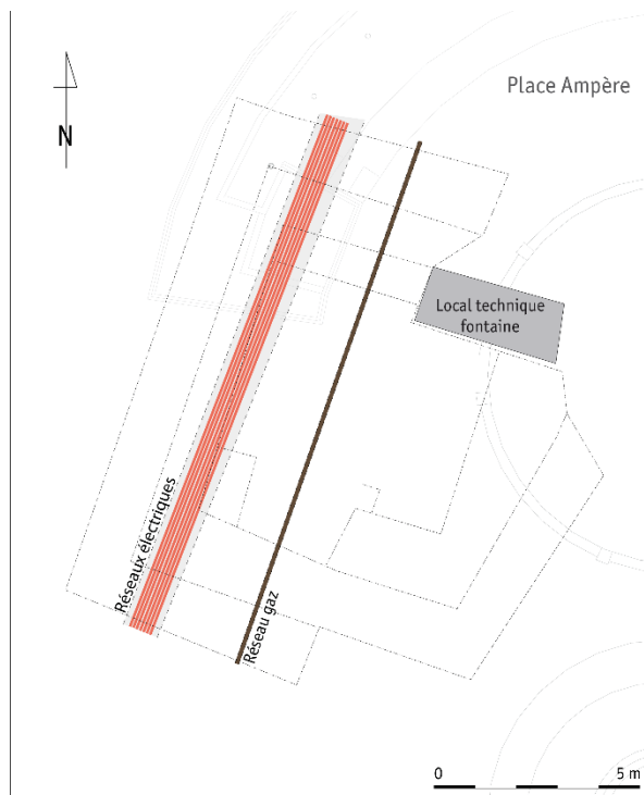
Fig. 1. Plan des réseaux consignés en cours d'opération.
