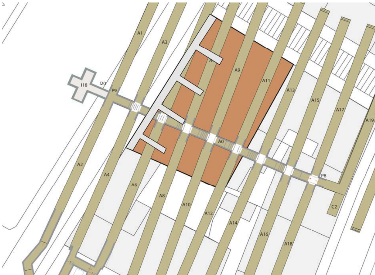
Fig. 7 : Terrain de boules et contreforts du 10 rue des Fantasques et réseau de galeries souterraines en « arêtes de poisson » (Extrait de la Pl. 28)
